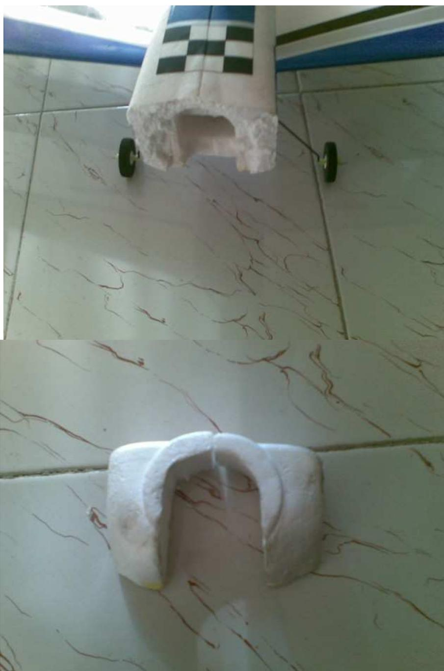
2) La seconda fase è stata quella di ricostruzione del supporto motore, modellandolo in base alla superficie di polistirolo del modello che, non essendo più uniforme, non permetteva la perfetta aderenza della vecchia sagoma. Vedi figura sotto
