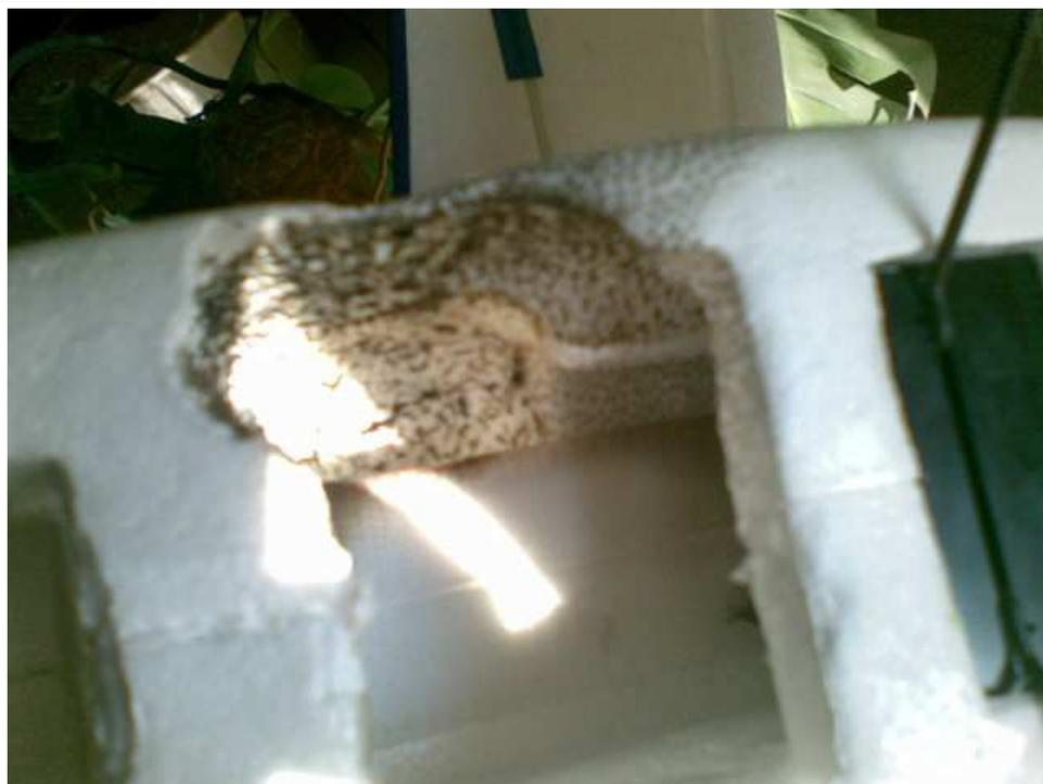
5) Per ricostruire la parte ormai disintegrata dalle fiamme ho deciso di usare la schiuma poliuretana monocomponente, colandola sulla parte bruciata.
